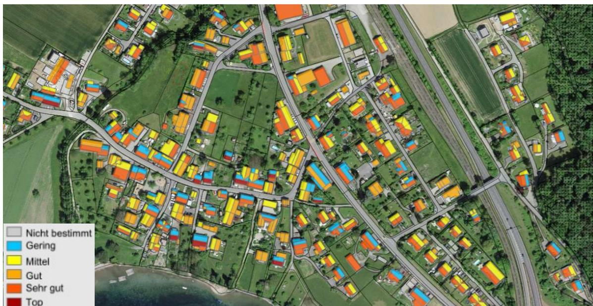
Abbildung 8 Potenzial Photovoltaikanlagen (Quelle BFE, Swisstopo; gis.sh)
